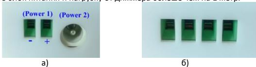
Рисунок 2 – Клеммы диммера: а) – входные (для подключения блока питания); б) – выходные (для подключения нагрузки) – маркировка нанесена на наклейку.
